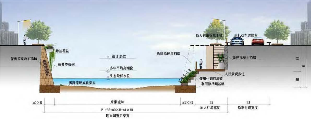
图63 10.2.5-6 现状河道改造示意图（单侧改造-单侧具备一定的用地条件）
