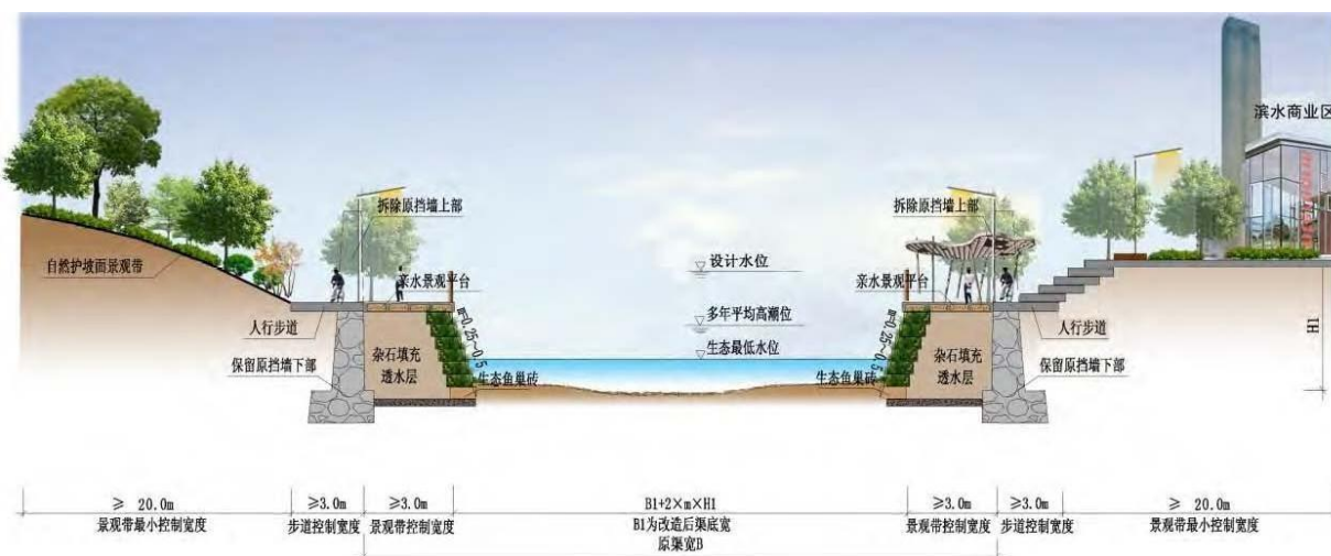
图66 10.2.5-9 现状河道改造示意图（双侧改造-双侧用地条件充裕）
