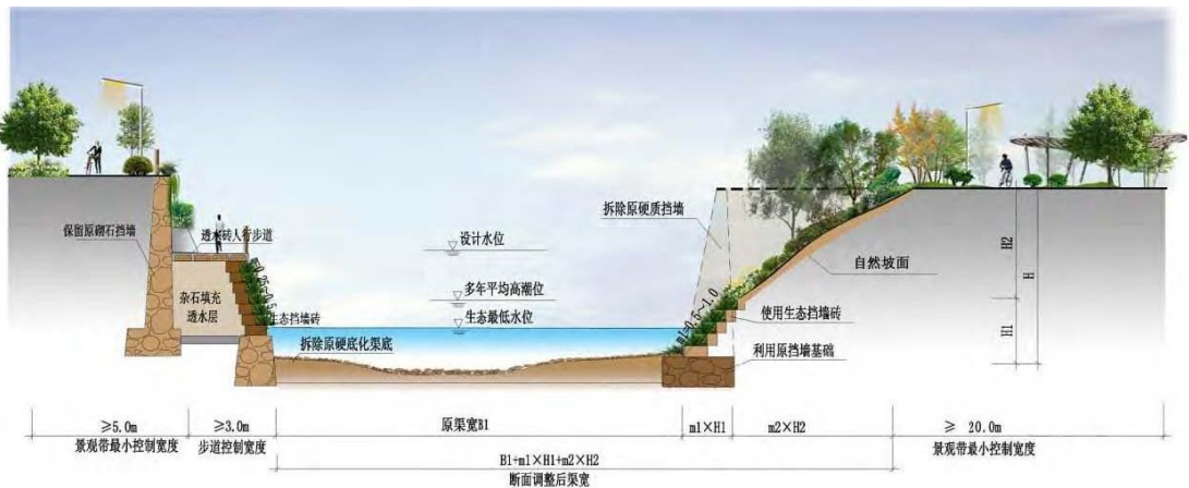
图62 10.2.5-5 现状河道改造示意图（单侧改造-单侧用地条件充裕）
