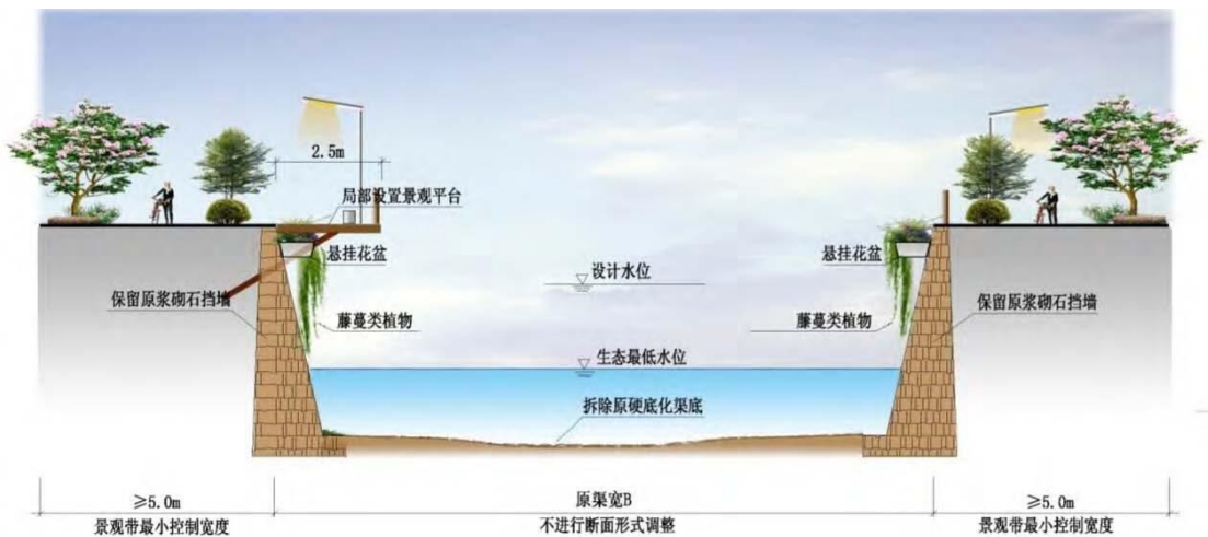
图58 10.2.5-1 现状河道改造示意图（两侧用地受限-纯景观改造）
