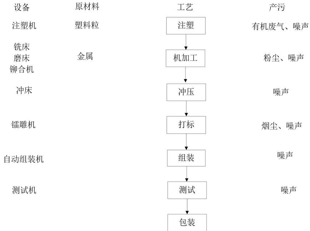
图 2-3 编码器生产工艺流程图
