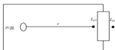
图 5. 室内声源等效为室外声源图
