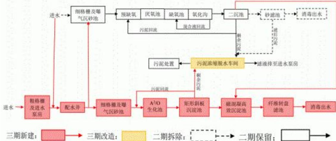
图7-2.20 荷塘污水处理厂污水处理工艺流程图
