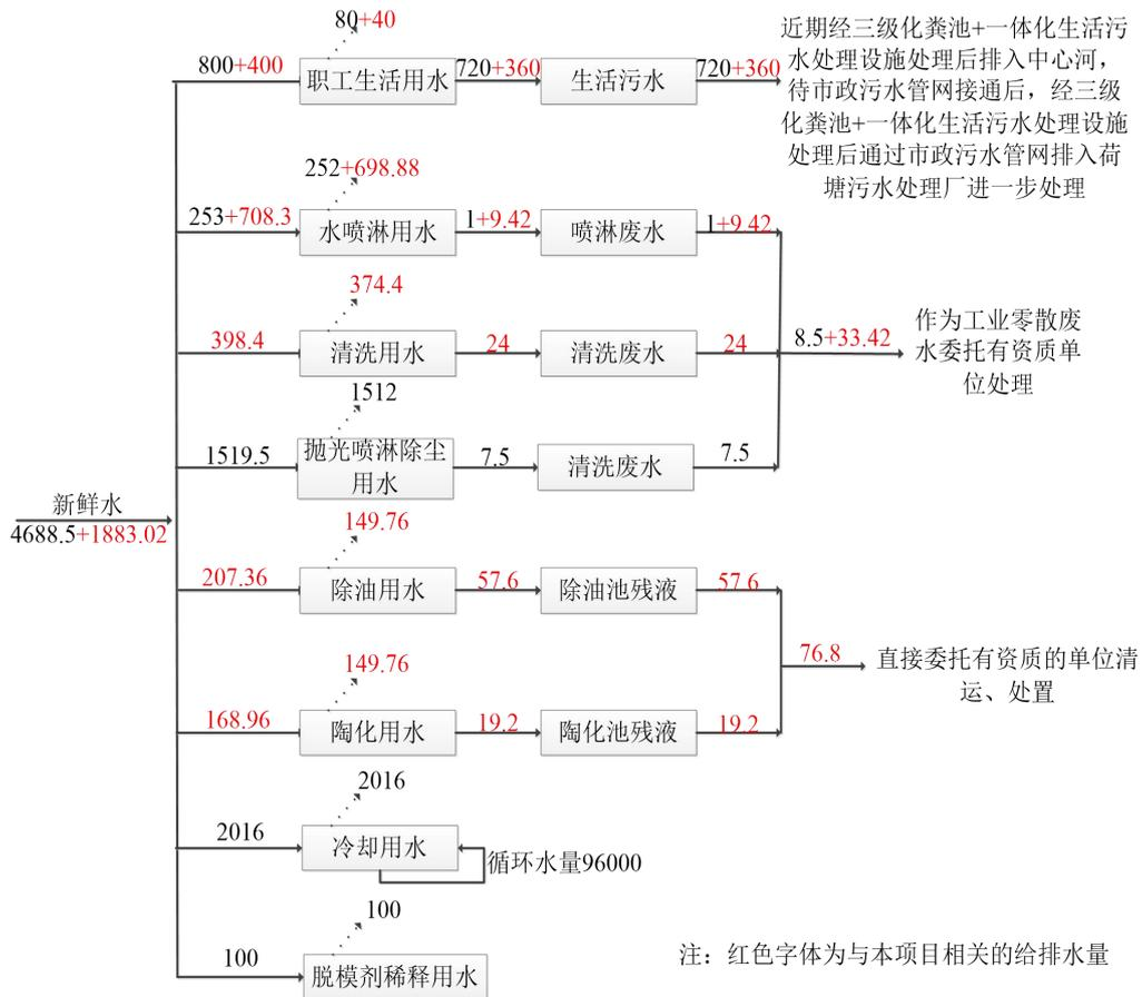
图 2-2 扩建完成后全厂水平衡图 (单位: m³/a)
