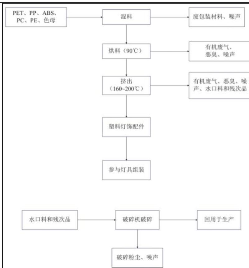
图 2-5 塑料面板生产工艺流程图
