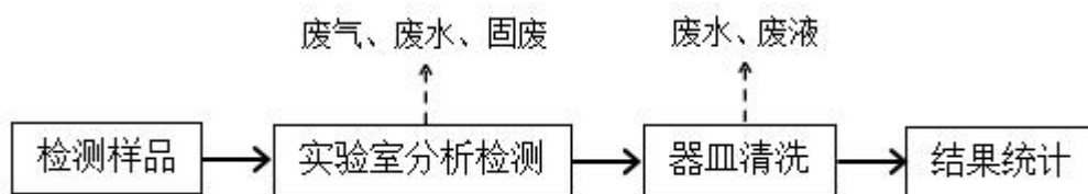
图 2-3 项目实验检测工艺流程图
