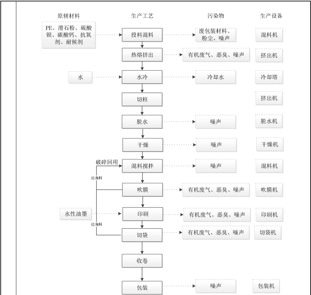
图 2-3 塑料袋工艺流程及产污环节示意图
