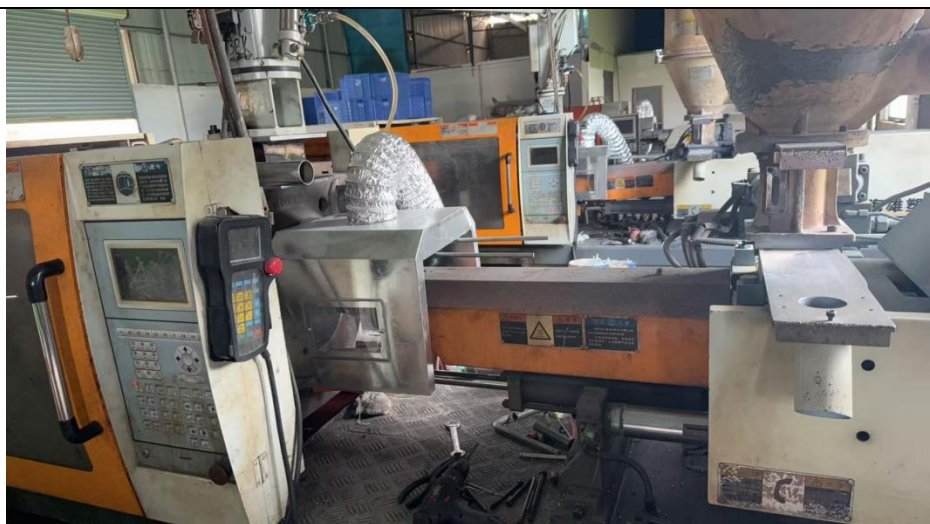
图4-1 注塑机废气收集示意图
