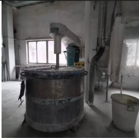
分散机-缸盖密闭抽风收集+围闭收集
