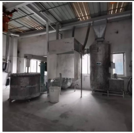
分散机-缸盖密闭抽风收集+围闭收集
