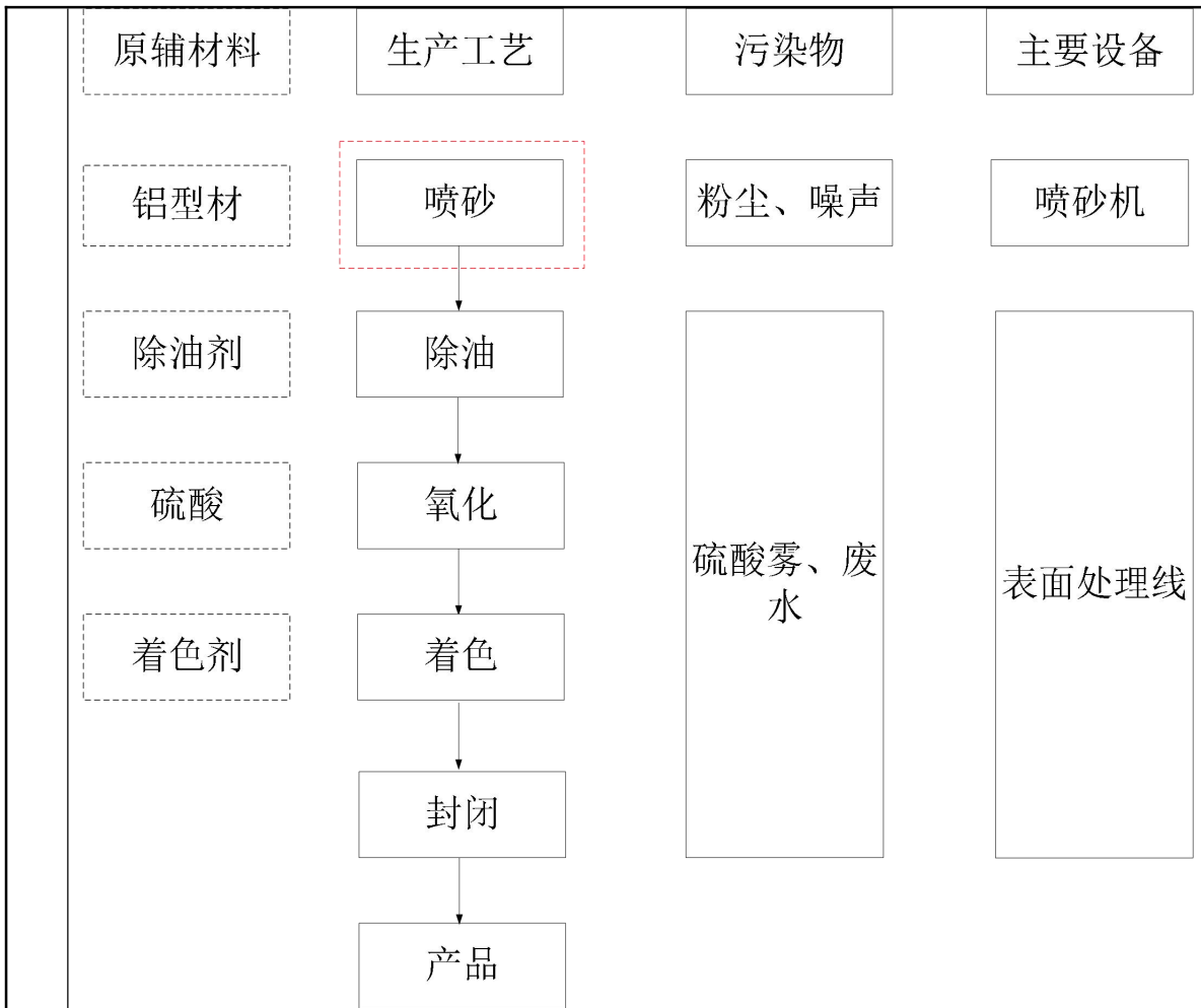
图 2-5 铝型材氧化、着色生产工艺流程
