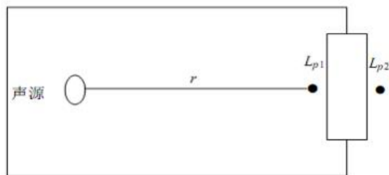
图43 室内声源等效为室外声源图例
