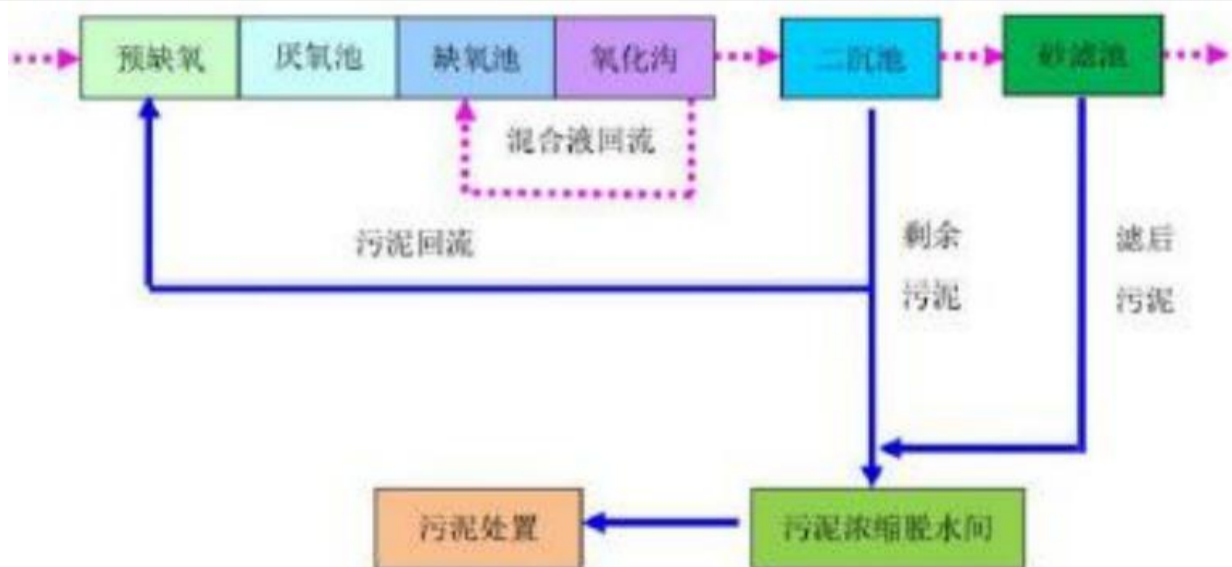
图 4-1 荷塘污水处理厂工艺流程图
