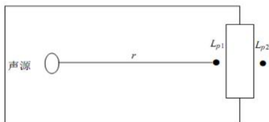
图4.5 室内声源等效为室外声源图例
