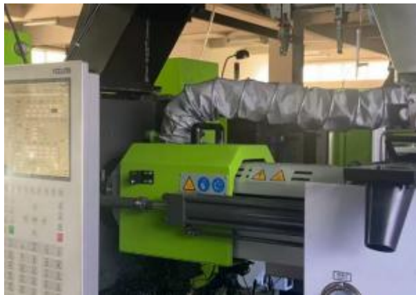
图 4-1 卧式注塑机半密闭型集气罩示意图
